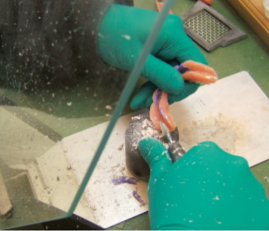
Abb. 18: Sicherheitssichtscheibe und Absauganlage
