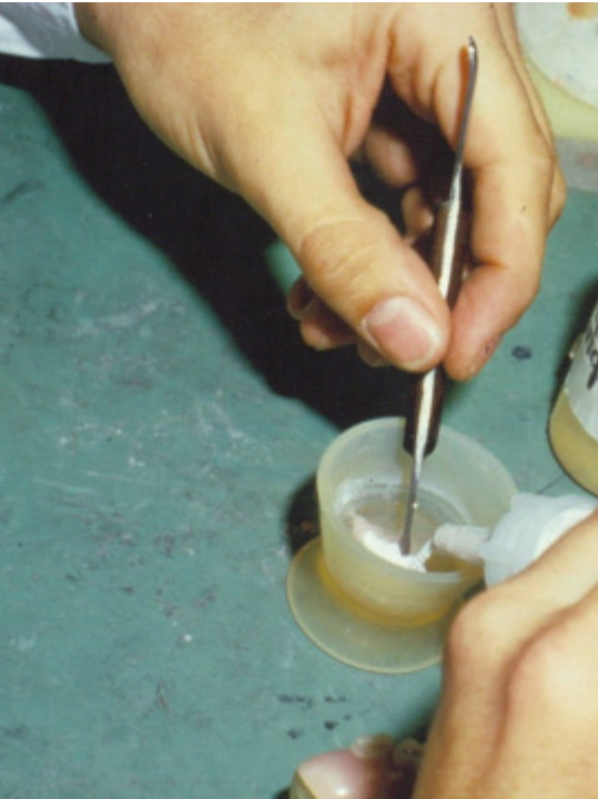
Abb. 14: Anrühren von Polymerpulver und Mono- merflüssigkeit mit einem Instrument
